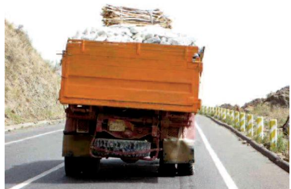
写真2 タイヤが歪むほど石灰石を積み、走行速度が徒歩速度よりも遅い車両過積載車両(エチオピア)。
