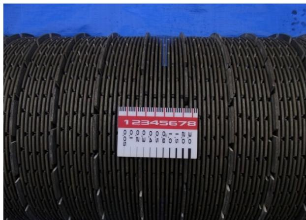
写真-1 ダイヤモンドブレード
