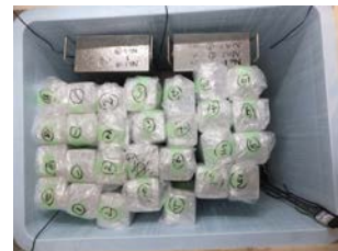
写真-3 養生状況 (60℃養生槽)
