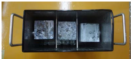
写真-2 ステンレス容器格納状況 (AAR-4 法)
