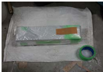
写真-1 供試体密封状況 (修正 JASS 5N 法)
