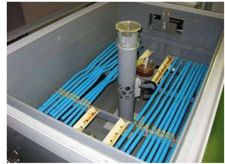
写真-2 耐食性試験状況
