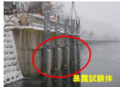
写真-1 暴露試験体の設置状況(当初)
