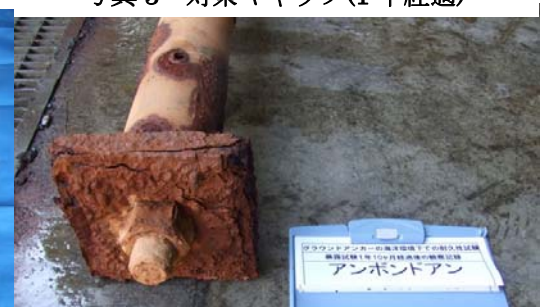
写真 5 高温槽設置防食無し供試体 (1 年 10 ヶ月経過)
