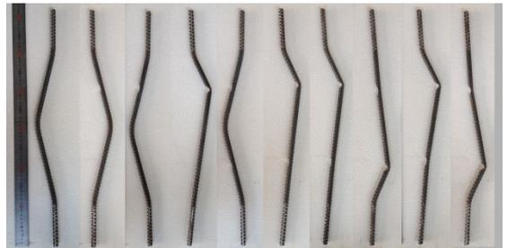
図 4 切削鉄筋の座屈形状 (32d-UD シリーズ)
