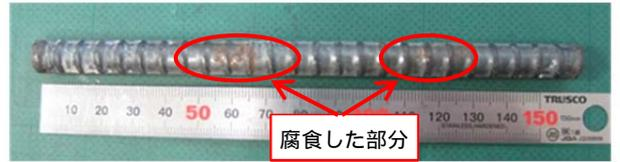
写真-2 腐食状況 (B5500 干満帯(T)かぶり 20mm)
