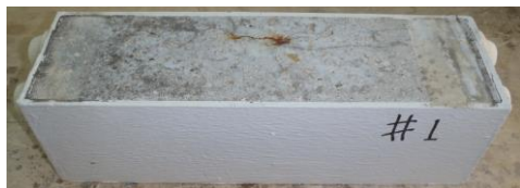
写真-2 #1の変状 (鉄筋腐食によるひび割れ)
