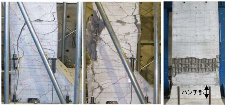
(a) 5δy-3回目 (最大荷重時) (b) 6δy-3回目 (繰返しにより荷重低下) (c) 試験終了時
