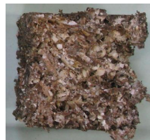
f) レッドオーク (浸漬 149 日) 8 点すべてで ピロディン打込み深さ 40mm 質量減少率 58.2%
