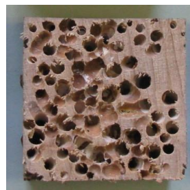
e) メーブル (浸漬 132 日) 8 点中 3 点で ピロディン打込み深さ 40mm 質量減少率 33.0%
