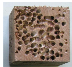
d) カバ (浸漬 121 日) 8 点中 1 点で ピロディン打込み深さ 40mm 質量減少率 23.2%
