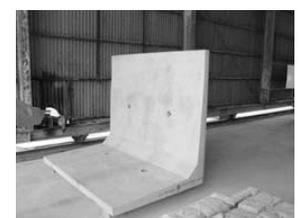
写真-3 試作製品(L型擁壁)
