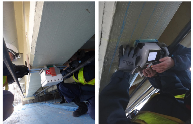
(1)磁石ユニットによる着磁 (2)磁気計測ユニットによる磁束密度測定 写真-2 鉄筋破断非破壊検査装置による実橋調査状況
