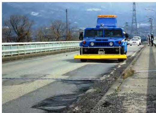
写真-1 探査車による橋梁の調査状況
