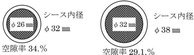
図-3 PC 鋼棒シーす断面
