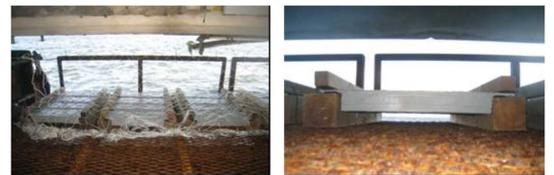
図-3 試験体の曝露状況
