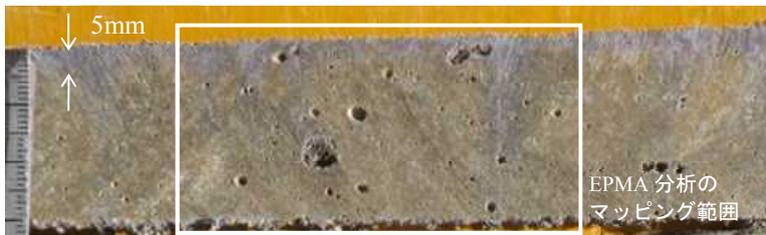
図-6 0.1N硝酸銀溶液の噴霧結果
