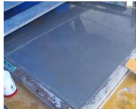
写真-3 部材の仕上げ状況
