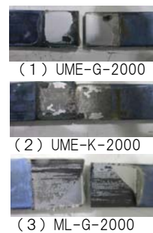
図 3 接着面の破壊状態
