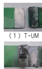
図 6 接着面の破壊状態
