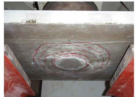
写真-1 押し抜き試験状況
