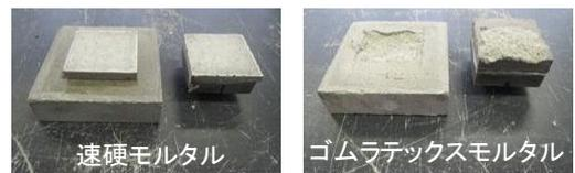
写真-1 付着供試体の破断面
