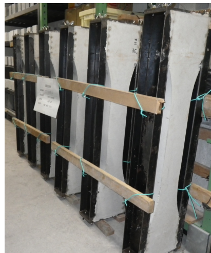
図5 拘束ひび割れ試験の実施状況
