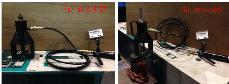
写真-1 付着強度試験の載荷状況
