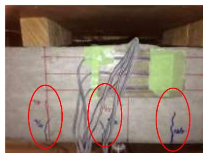
写真1 曲げひび割れの様子(丸枠内)
