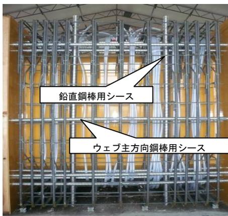
写真-2 供試体作製状況 (側面)
