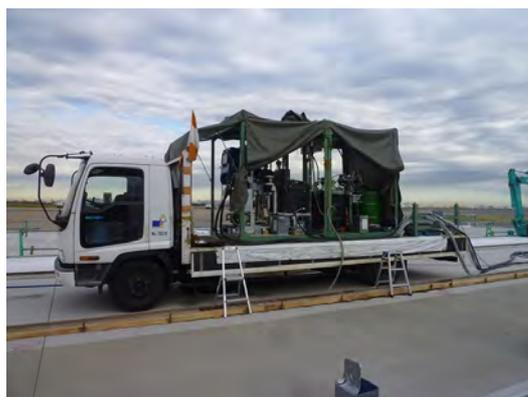
写真-2 接着剤ポンプユニット(車載状況)
