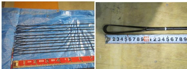
写真-1 SCF ロッド(左: 全景, 右: U 型部接写)
