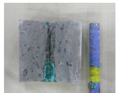
図2 引抜き試験結果と付着状況 (普通鉄筋と GP コンクリート)
