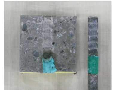
図1 引抜き試験結果と付着状況 (普通鉄筋と N コンクリート)
