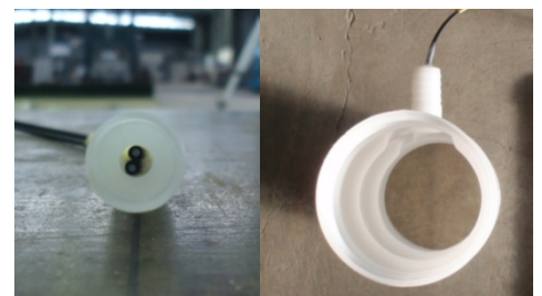
写真-1 光ファイバセンサーの取付
