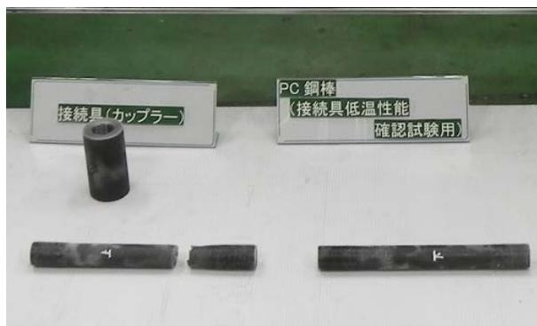
写真-2 破断状況 (接続具の低温性能確認試験)
