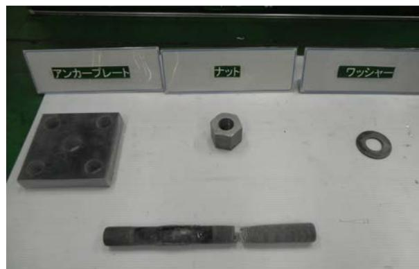
写真-1 破断状況 (定着具の低温性能確認試験)
