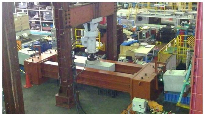
図 - 5 フレットング疲労試験状況
