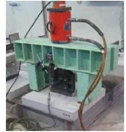
写真-1 引抜き試験状況
