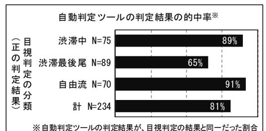
図4 自動判定ツールの判定精度
