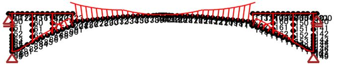
図-4 死荷重, 集中荷重載荷時のモーメント図
