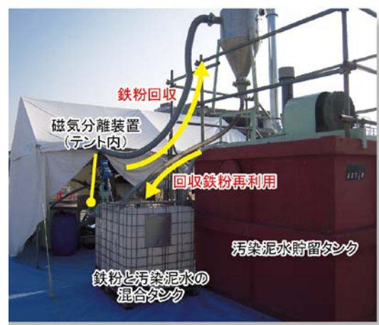
写真-2 砒素汚染泥水の処理実験状況
