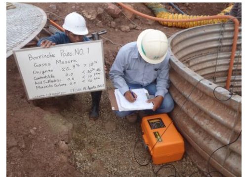
写真-4 酸素濃度測定状況
