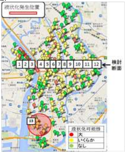
図1 3.11による液状化発生位置と観測最大加速度値に基づいた道路橋示方書による液状化判定結果
