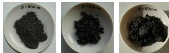
写真-1 粒状固化処理の状況
