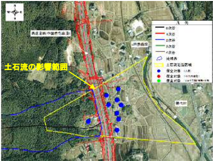
図-7 保全対象等の状況(土石流影響範囲)
