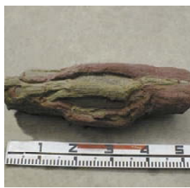
写真2 繰返し注入による補強体の造成例
