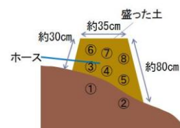
図-4 実験の盛土
