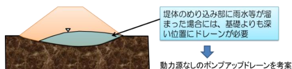
図1 堤体内の閉封飽和域と部分液状化
