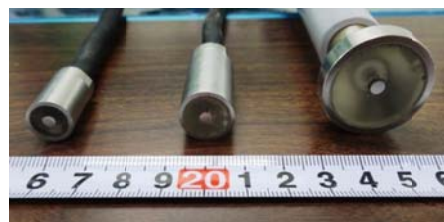
写真-1 FDR-V 測定プローブ
