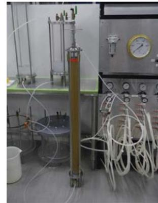
写真2 1m浸透試験状況
