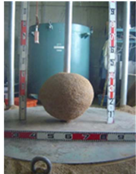
写真-1 ゲルの固結体
