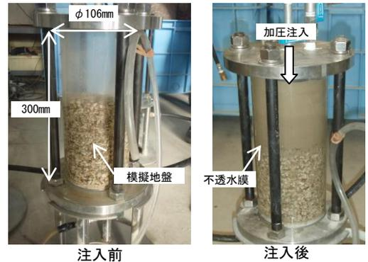
図-4 新注入材での加圧性能確認試験
