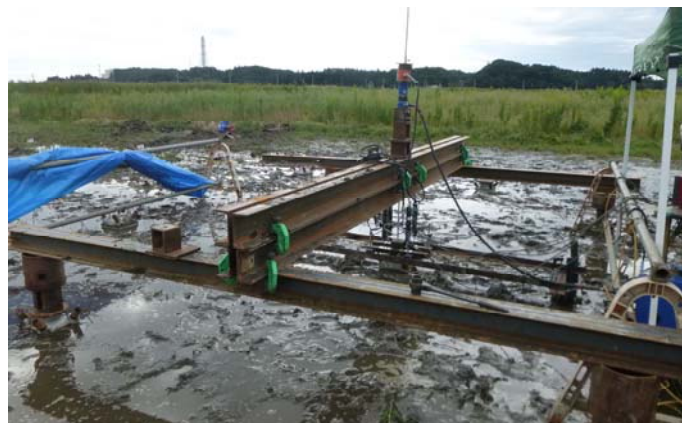
図2 鉛直載荷試験状況
