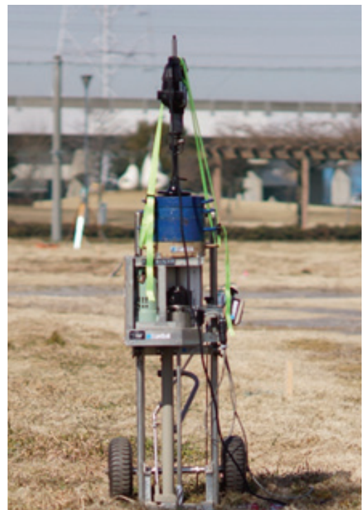
写真-1 DWS試験の全景
