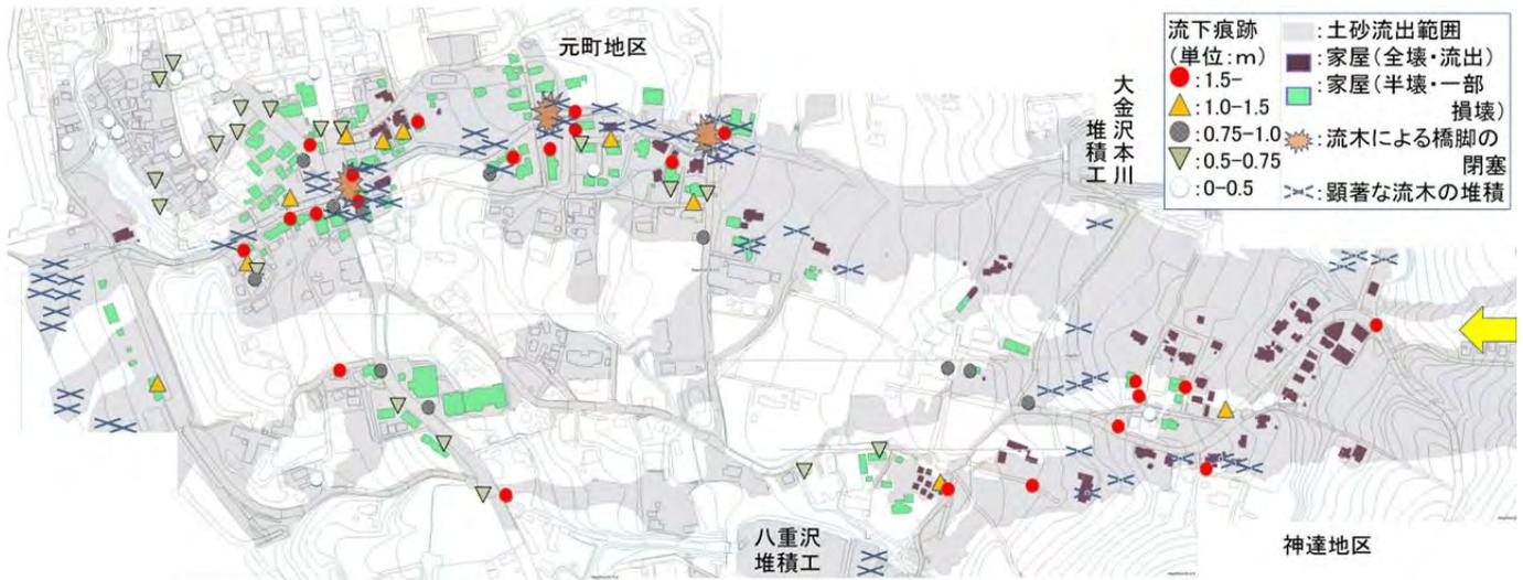
図3：伊豆大島土石流の災害状況と家屋の破壊状況
