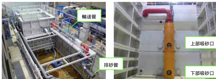
写真-1 実験設備 (左: 設備全体、右: 鉛直二重管)
