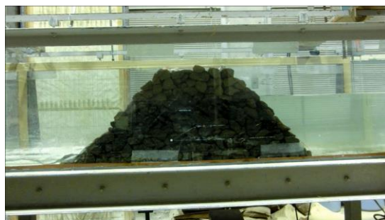
図-2 水槽内に作製したバラスト道床
